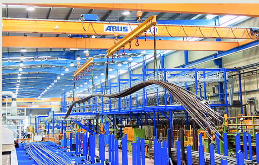
Para manipular barras y fajos largos, Abus desarrolló para Transmesa una solución basada en puentes grúas con unos testeros más largos y un solo carro adaptado con dos polipastos integrados.
